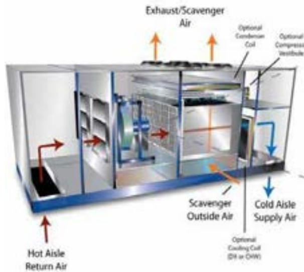
Figura 36: Schema economizzatore con raffreddamento evaporativo indiretto
