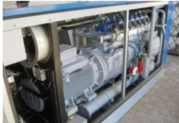
Fig. 4 – Cogeneratore da 60 kW el .
