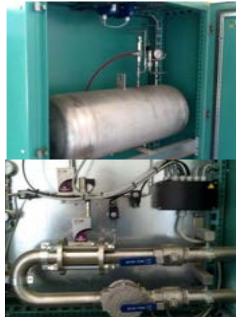
Fig. 10 – Schema del dispositivo di miscelazione ed immagini del complessivo montato.
