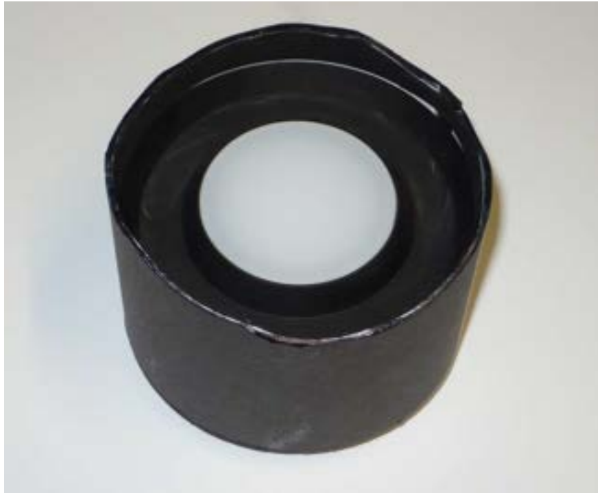
Figura 52 Adattatore per la misura dell'irradianza spettrale, dotato sistema per la limitazione del campo visivo
