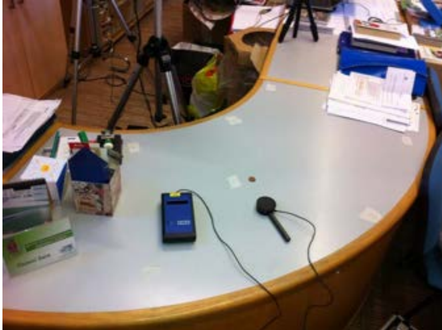
Figura 45 Misura degli illuminamenti sulla scrivania del bibliotecario
