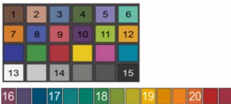
Fig 5: 20 campioni di colore per il calcolo dell'indice di resa cromatica di Brodogi. I campioni 13, 14 e 15 vennero in seguito scartati.
