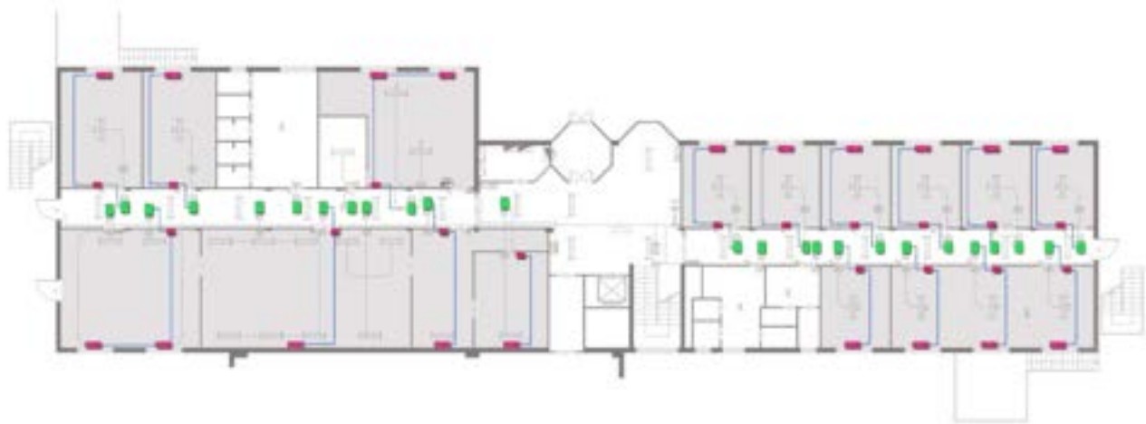
Disposizione dei fan coil, dei termostati dei trasmettitori di segnale Elios
