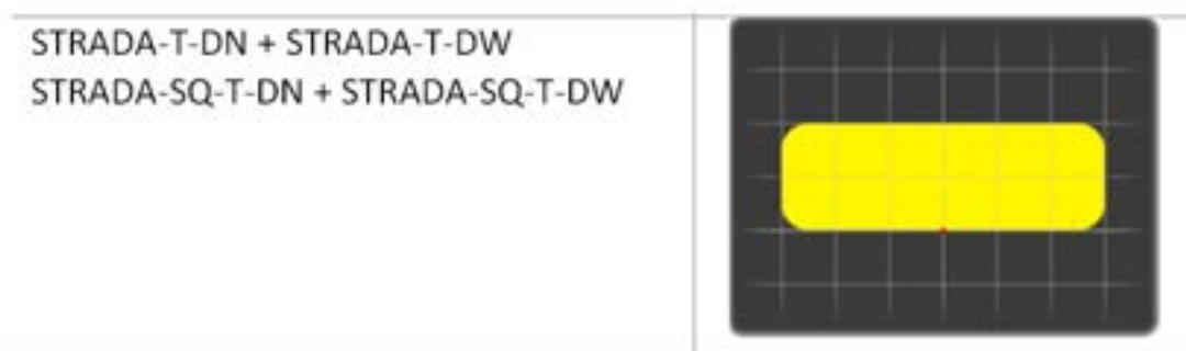
Figura 64 Distribuzione sulla carreggiata dovuta all'impiego di una lente DW e di una lente DN La distribuzione fotometrica, ottenuta dalla combinazione delle due lenti indicate è riportata alla Figura 65: occorre osservare che il valore delle intensità luminose per angoli \gamma compresi tra 75^\circ e 90^\circ risulta ancora molto elevato: questo dipende dal fatto che il costruttore fornisce i dati fotometrici misurando ne l'emissione con il solo PCB. Il cut-off della distribuzione è demandato all'utilizzatore il quale dovrà provvedere a schermare opportunamente l'emissione luminosa in modo da rispettare i limiti di abbagliamento (parametro TI%) e quelli relativi all'inquinamento luminoso che prevedono un'emissione inferiore a 0.50 cd/klm per angoli \gamma superiori o uguali a 90^\circ , rispetto alle verticale.
