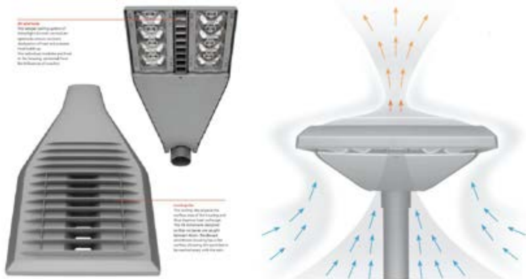
Figura 53 Esempio di sistema di dissipazione integrato con l'apparecchio che sfrutta l'effetto camino (fonte:SITECO) La seconda soluzione, sebbene più impegnativa dal punto di vista della fase di prototipazione, dovrebbe consentire migliori risultati con minore consumo di materiali e un aspetto estetico del prodotto maggiormente gradevole.
