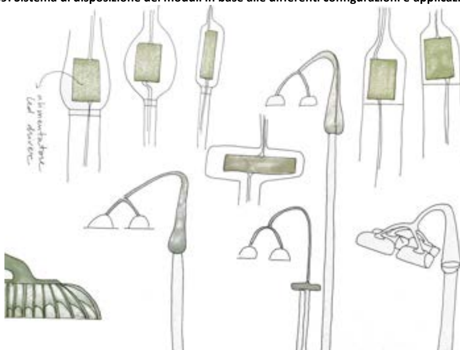
Figura 90: L'aggancio al palo diviene elemento funzionale al contenimento degli ausiliari elettrici
