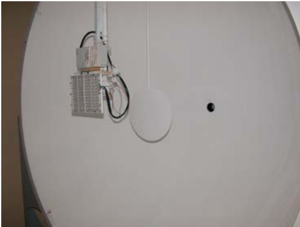
Figura 9 Montaggio apparecchio all'interno della sfera integratrice per la misura spettrale
