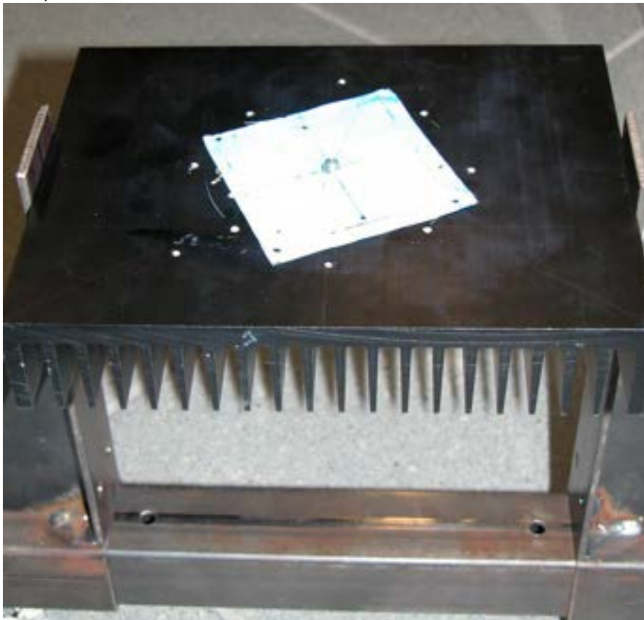
Figura 3 Dissipatore utilizzato per le prove dei moduli LEDIL Strada 2x2 e relativa interfaccia termica
