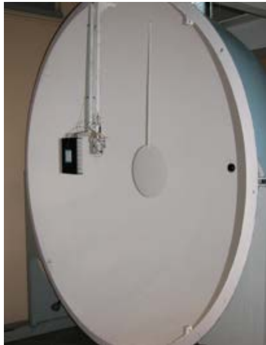
Figura 10 Montaggio del dissipatore commerciale all'interno della sfera integratrice. Questa soluzione consente il rapido montaggio di sistemi ottici di diversi costruttori all'interno della sfera per la loro misura colorimetrica
