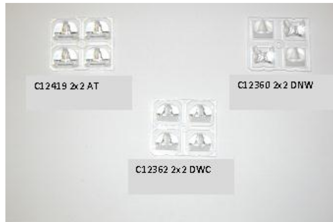
Figura 13 Sistemi ottici LEDIL misurati
