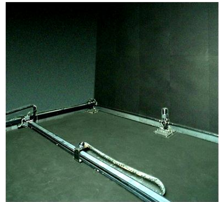
Laboratorio ENEA di Ispra: cella di prova con movimentazione elettromeccanica x-y del sensore di misura
