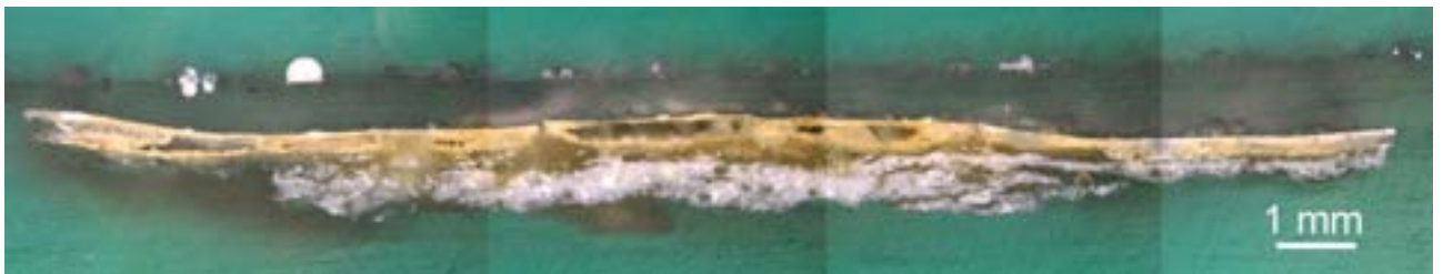
Fig. 27. Immagine in microscopia ottica della stratigrafia del campione 2
