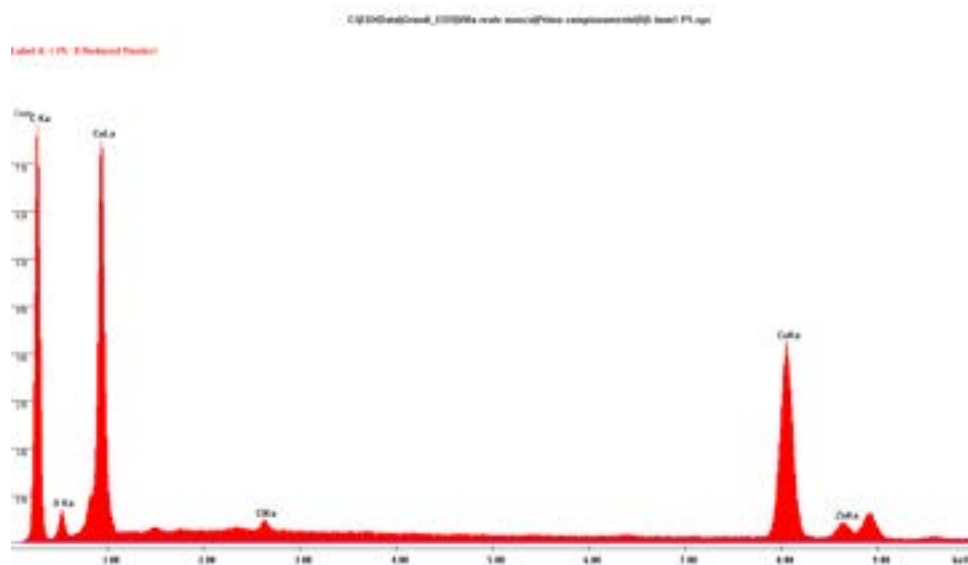
Fig. 51. Spettro EDX riferito alla lamina metallica più superficiale.
