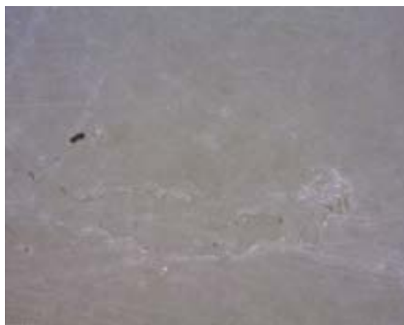
Fig. 19. Particolare al microscopio del bianco Bianco di Carrara. L'immagine mostra suture stilolitiche, riferibili alla tessitura originaria del materiale.
