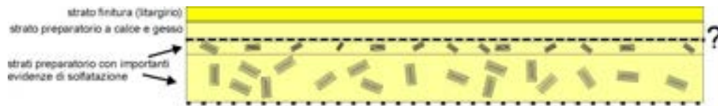
Fig. 40. Schema interpretativo della stratigrafia dell'intonaco (campione 2 e 3)
