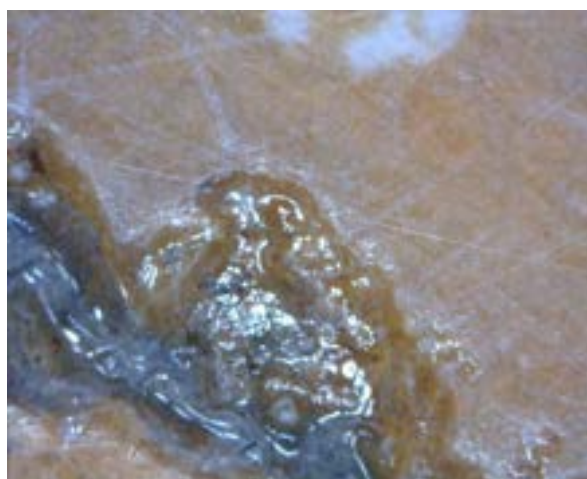
Fig. 17. Particolare allo stereomicroscopio del Rosso di Verona. Dettaglio di un intervento su frattura
