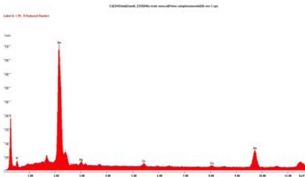
Fig. 49. Spettro EDX della lamina metallica più interna, presente nel campione 5 (vedi Fig. 45 B). La presenza di tracce di Cromo e Piombo sono da attribuire alla interferenza del sottostante strato di pigmento giallo cromo
