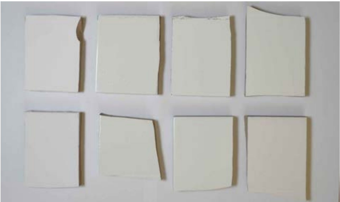
Figura 20. Campioni smaltati. In alto: B2, B2+Cristallina, B2+Bianca, B2+Matt In basso: C2, C2+Cristallina, C2+Bianca, C2+Matt
