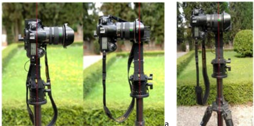
Figura 15. Evitare errori di parallasse. Il pallino verde rappresenta il punto nodale, mentre la linea rossa è l'asse di rotazione del cavalletto. a) posizionamento scorretto; b) posizionamento corretto
