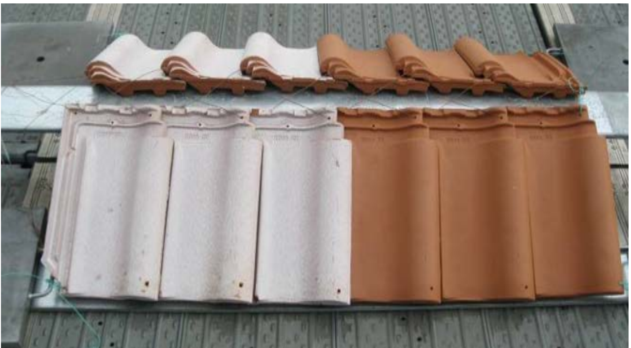
Figura 9. Tegole intere esposte a Milano, presso il Politecnico di Milano.
