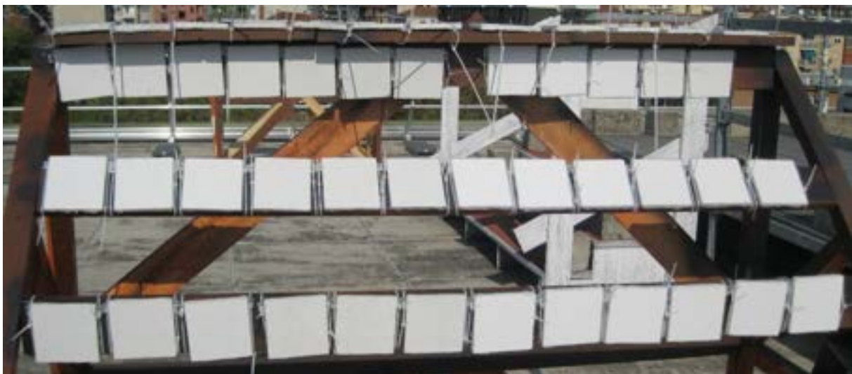
Figura 2. Campioni di malte per pannelli per facciata ventilata esposti a Milano.
