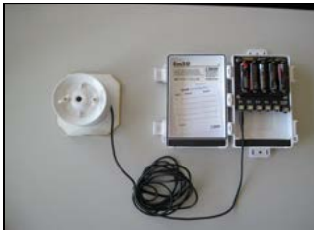
Fig.1: Termo-igrometro (sinistra) e acquisitore DECAGON EM 50
