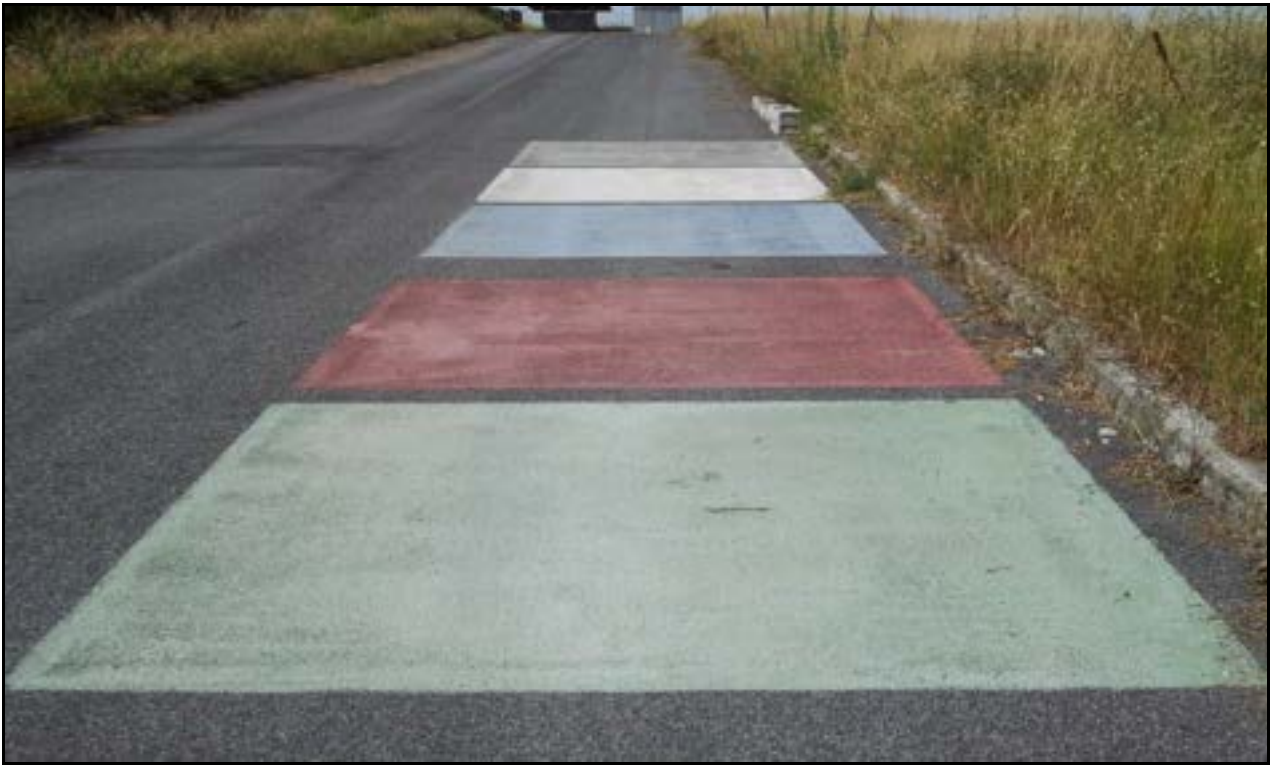
Fig. 6: Area di asfalto dipinta con le tinte ad elevata riflettanza solare.
