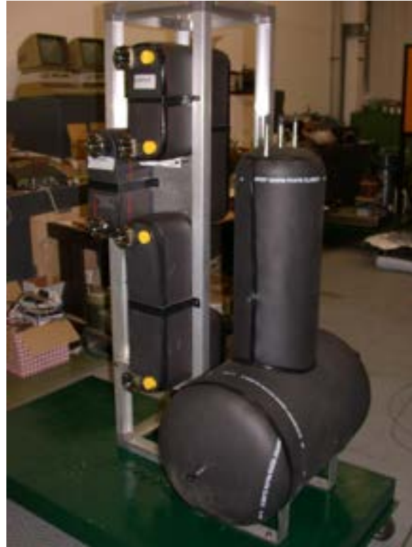
Figura 10 – Il prototipo ENEA da 18 kW: fase di montaggio
