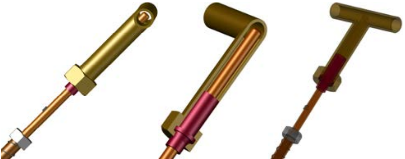
Fig. 3.5: spaccato dell'accoppiamento heat pipe.collettore
