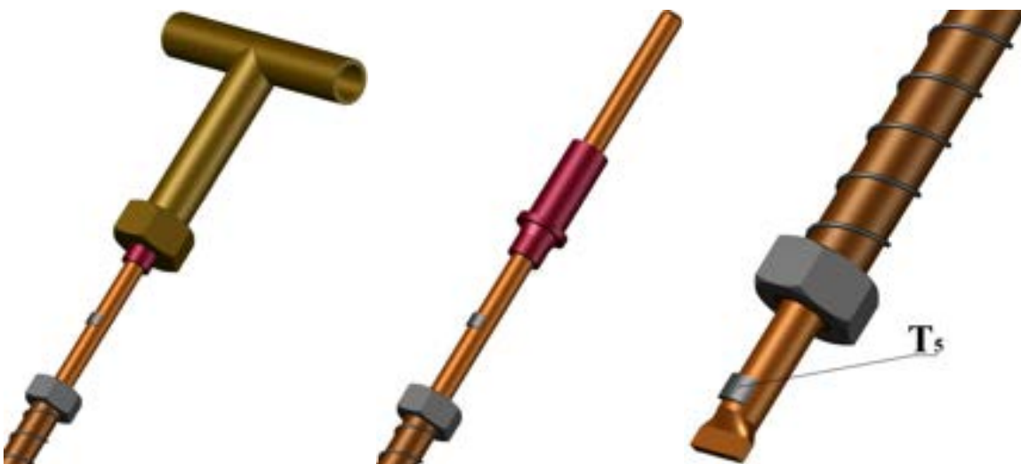
Fig. 3.5: spaccato dell'accoppiamento heat pipe.collettore
