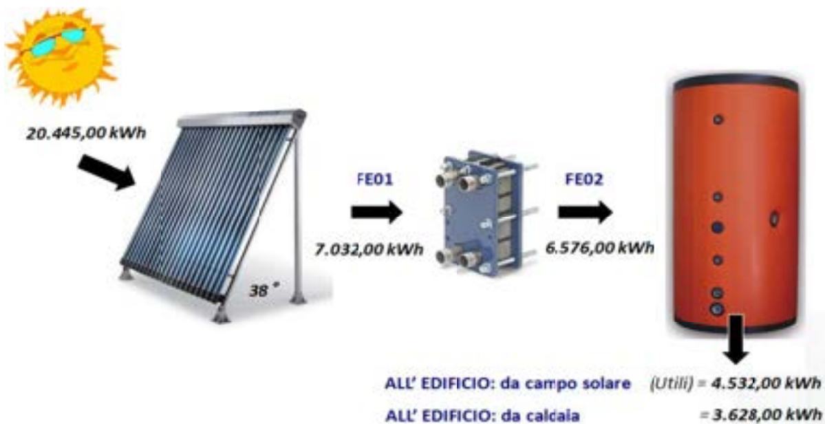
FIGURA 57: Schema produzione e fornitura energia a partire dai collettori solari durante il monitoraggio invernale
