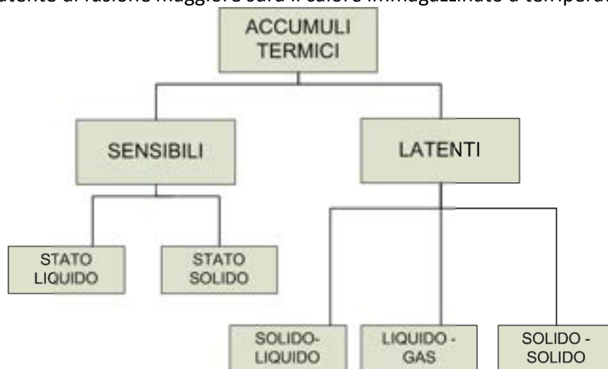
FIGURA 11: Classificazione degli accumuli termici a breve termine
