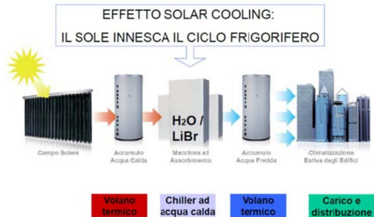
FIGURA 12: Logica di funzionamento impianto solar cooling
