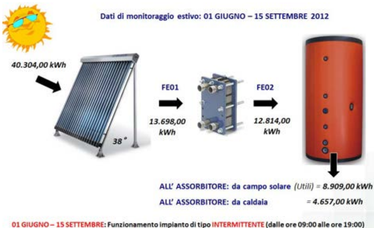
FIGURA 108: Schema produzione e fornitura energia a partire dai collettori solari (estate)
