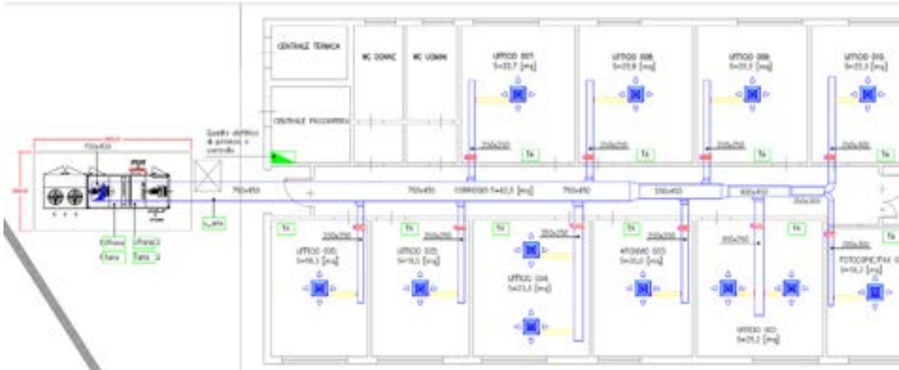
Figura 29. Layout impianto distribuzione aria servito da roof-top
