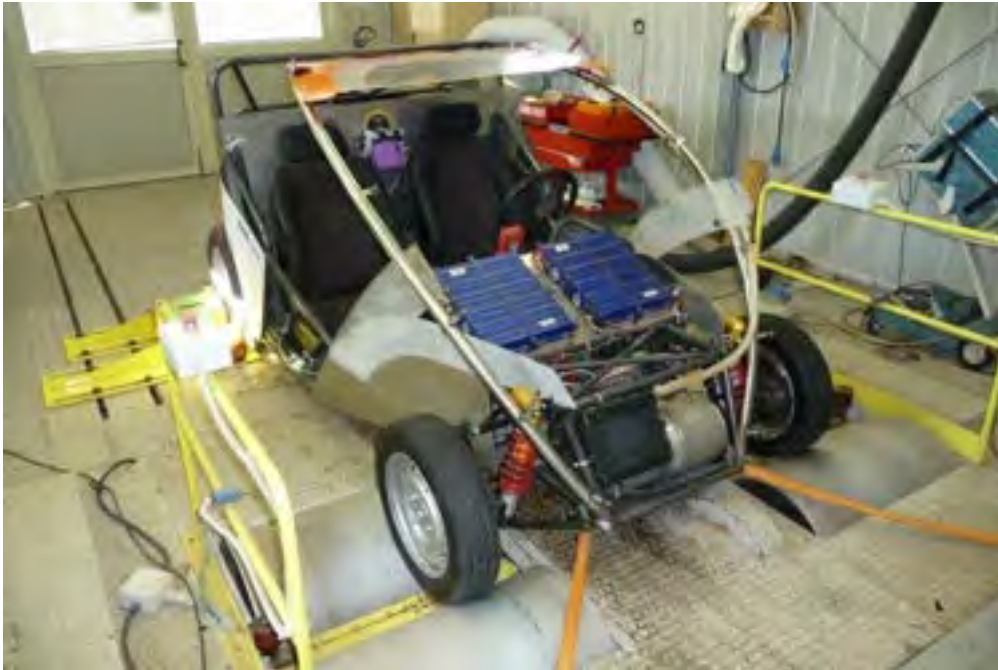
Figura 31 - Il veicolo in prova al banco a rulli
