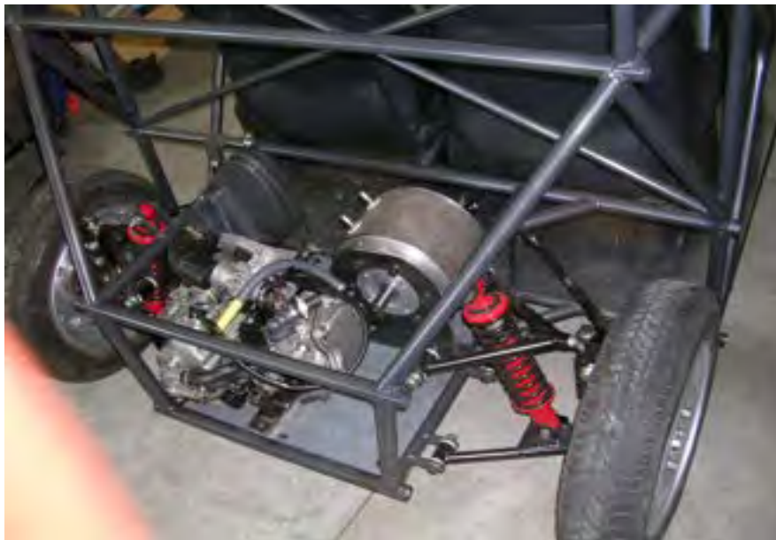
Figura 14 - Alloggiamento del gruppo motogeneratore (GU) sulla piastra posteriore del veicolo
