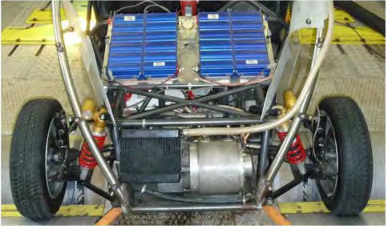
Figura 15 - Foto dell'assale anteriore del veicolo: motore di trazione e i supercondensatori
