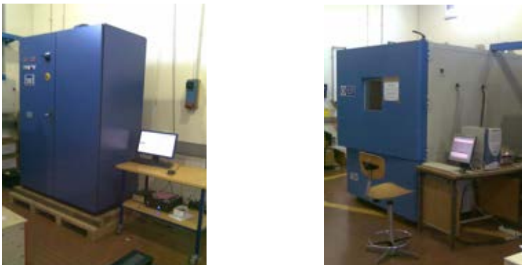
Figura 39 - Ciclatore (sinistra) e camera climatica (destra) usati per le prove
