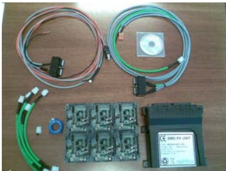
Figura 19 - Componenti del BMS acquistato
