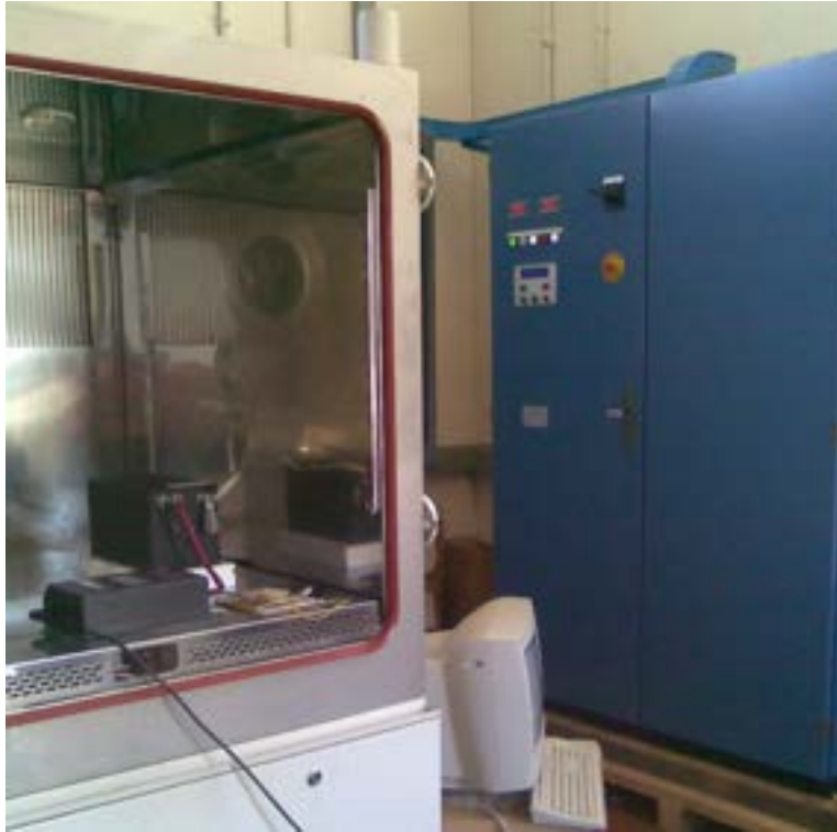
Figura 61 – Camera climatica (sinistra) e ciclature (destra) usati per i test del sistema 48V – 20Ah
