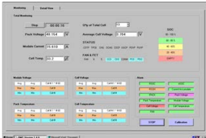
Figura 57 – Schermata principale del BMS del sistema 48V – 20Ah
