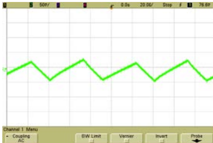
Fig. 6.2.8) Corrente complessivamente erogata dal banco di supercondensatori (scala correnti 5A/div; scala tempo 20 \mu s/div)
