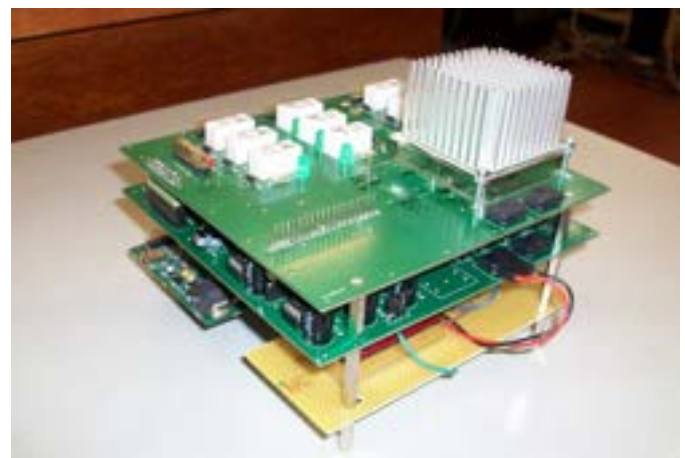
Fig. 6.2.4) Vista di insieme della Unità Elettronica di Controllo (ECU) con tre schede dedicate alla logica di gestione, all'acquisizione segnali ed alla loro gestione
