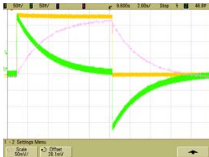
Fig. 6.2.10) Inserimento e disinserimento di un carico resistivo (scala correnti 5A/div; scala tempo 2s/div)
