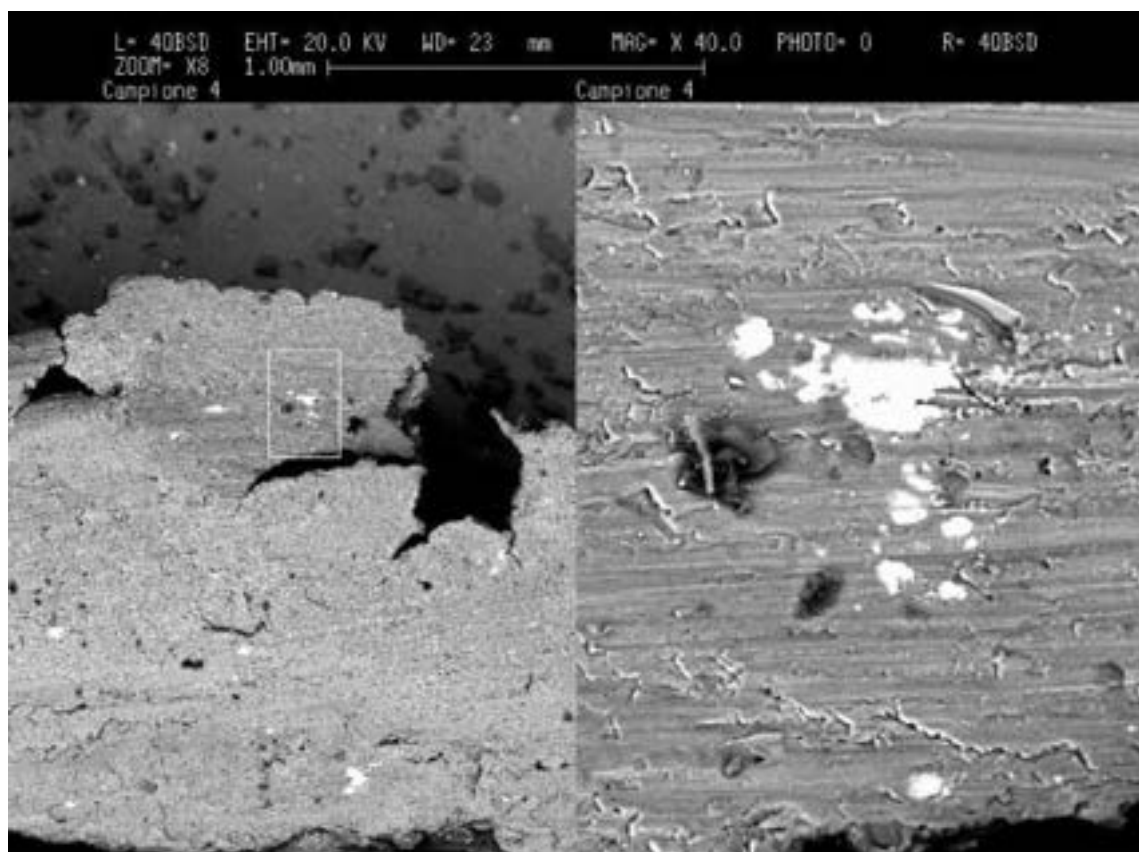
Fig.7: Schiuma ottenuta da polveri con composizione: 2.8 wt% \text{SiC} , 0.6 wt% \text{TiH}_2 . (sinistra) il bordo del poro; (destra) Il dettaglio indicato nell'immagine di sinistra ingrandito 8X. Misure EDS effettuate sulle parti più chiare indicano un rapporto \text{Ti}:\text{Al} di circa 1:3 corrispondente al composto intermetallico \text{Ti}_3\text{Al} .
