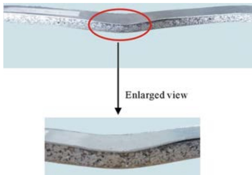
Fig. 64: deformazione plastica del cuore in schiuma di alluminio a cella aperta [53].
