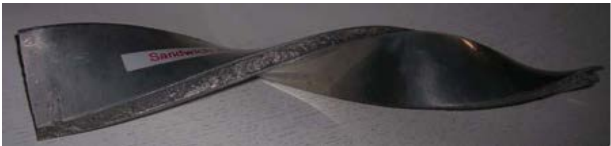
Fig. 70: sandwich in schiuma di alluminio con struttura 3D ottenuta tramite modellazione del composito [55].
