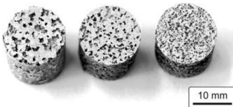
Fig. 44: schiume di Al con grandezza media delle celle di: 1.35, 0.7, 0.35 mm (da sinistra a destra) [48].
