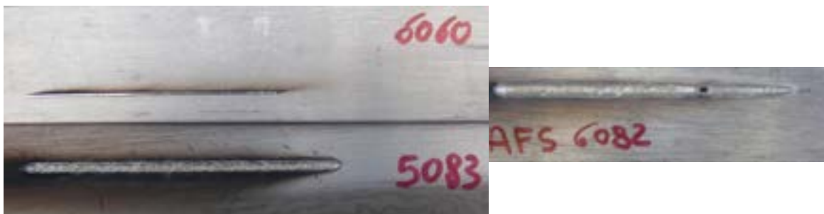
Figura 5: Differenti effetti del laser su diverse leghe di alluminio
