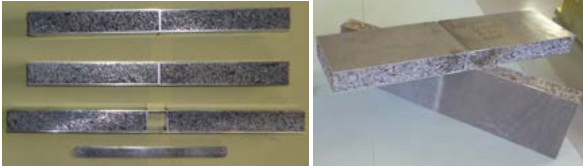
Figura 42: Foto di alcuni campioni di qualifica 100x 400 x 30 mm per la realizzazione dei provini per test a flessione su 4 punti.
