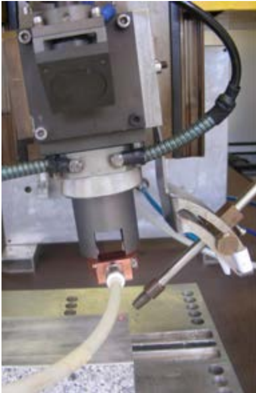
Figura 6: Set Up con lama d'aria (pressione 5 Bar); a DX il controllo dello stato de vetrino di protezione dopo 10 prove non mostra segni di spatter ad indicare una buon efficienza di protezione della lama d'aria.
