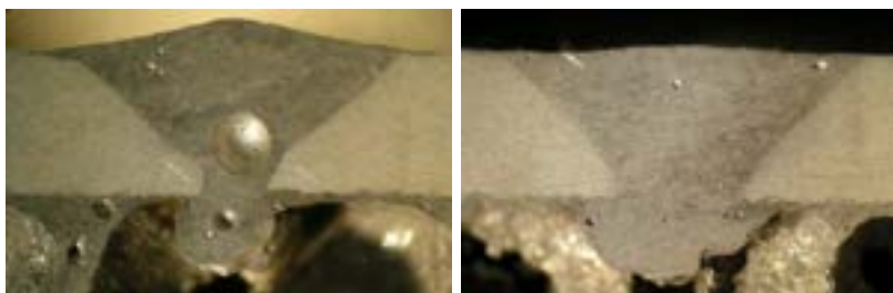
Figura 30: BAFS_WLT3: Dx parte iniziale con Gap 0.3mm; Sx parte finale con Gap 0.5mm.
