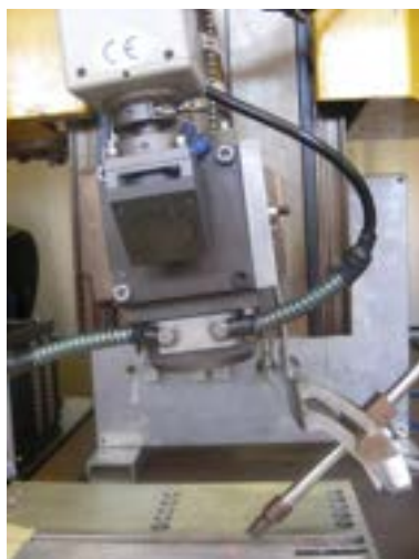
Figura 4: Foto e schema del Set Up di saldatura con solo laser di leghe di alluminio
