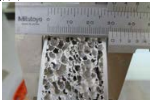
Figura 1: Foto Tipica dei pannelli AFS utilizzati e tabella delle caratteristiche principali
