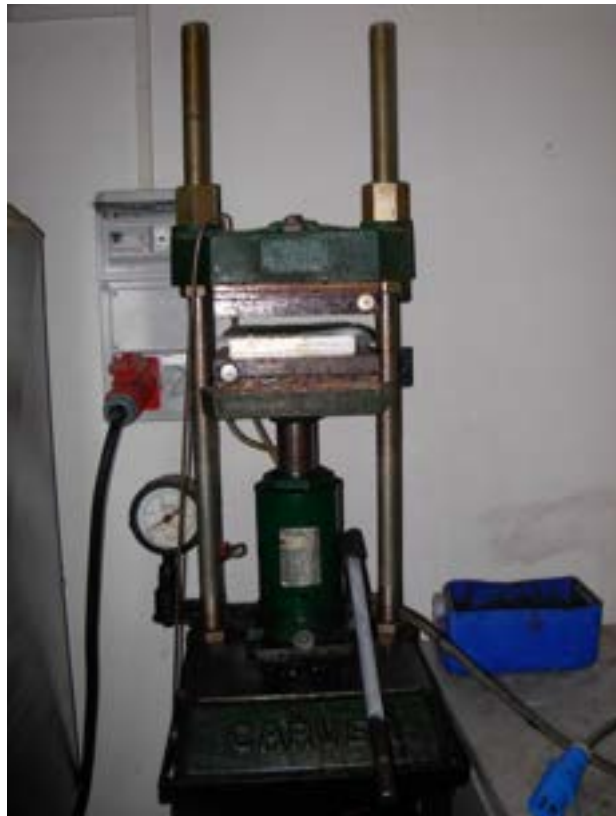
Fig. 15. Posizionamento in pressa dello stampo.
