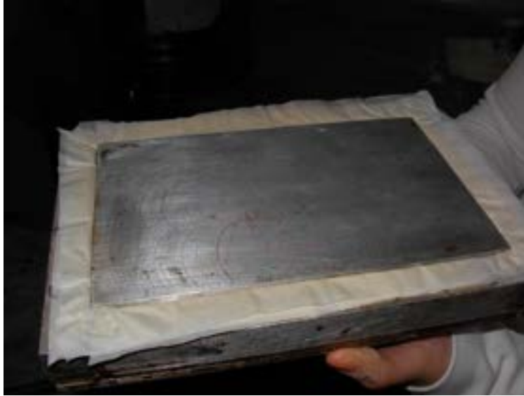
Fig. 14. Stampo chiuso e pronto per la pressa
