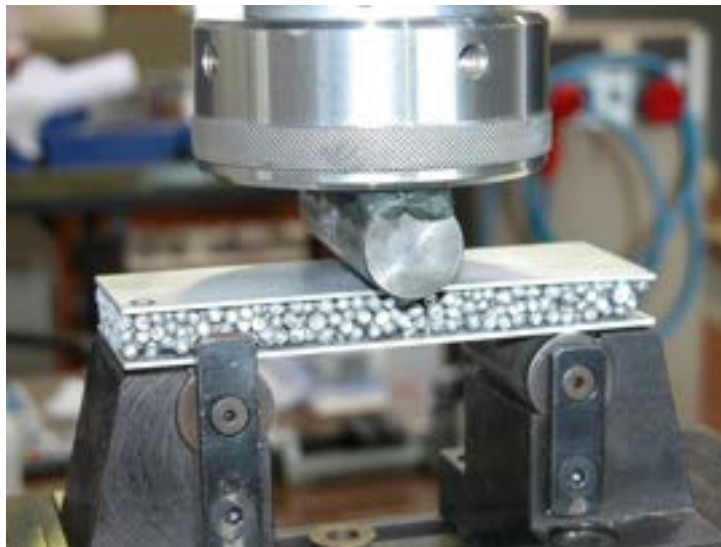
Fig. 9. Attrezzatura per prove di flessione e campione 0 montato sulla stessa
