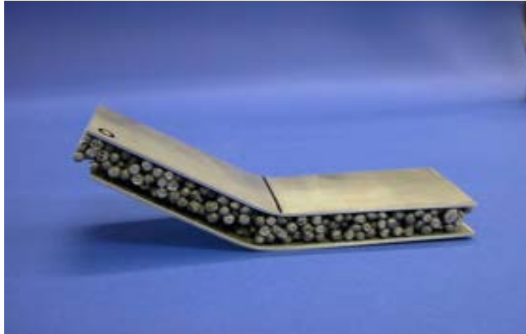
Fig. 36. Dettaglio della parziale delaminazione della lamiera inferiore (lato sinistro)
