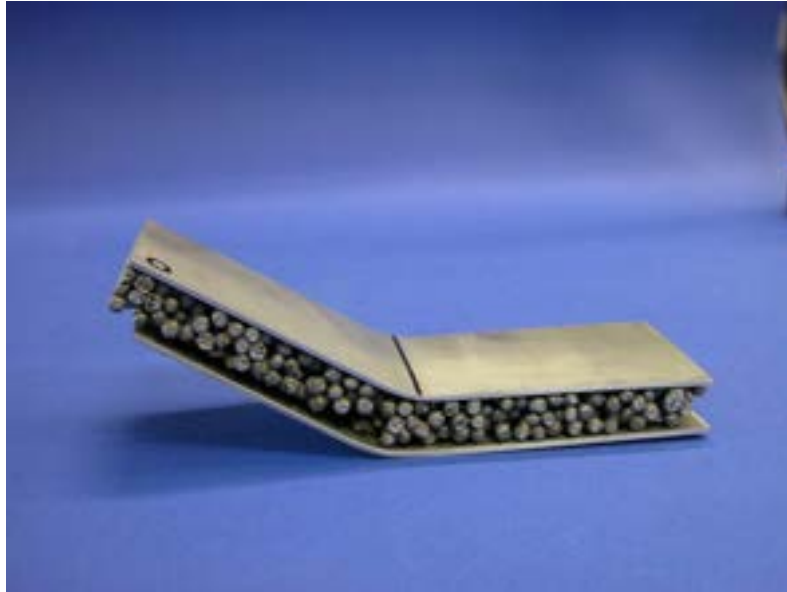
Fig. 11. Dettaglio della parziale delaminazione della lamiera inferiore (lato sinistro)
