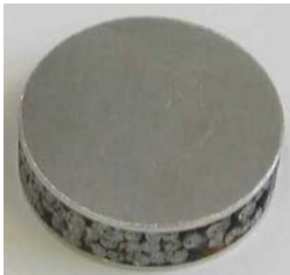
Figura 3: Campioni di materiale cellulare per misure di conducibilità termica
