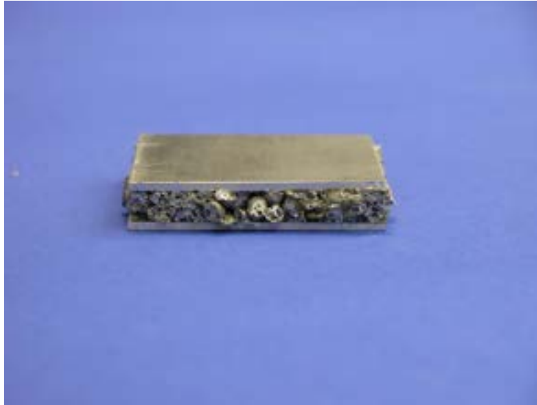
Fig. 8. Campione 1 dopo prova di compressione
