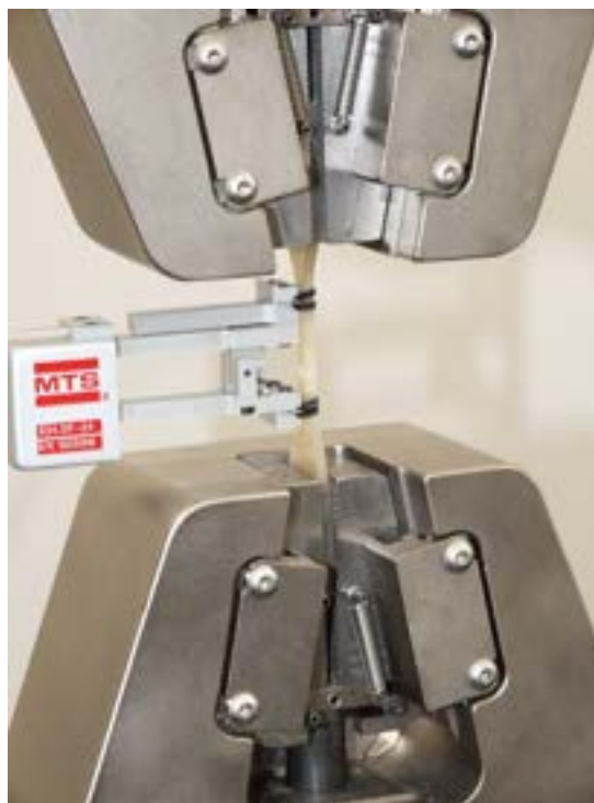
Fig.13 Particolare della prova a trazione eseguita
