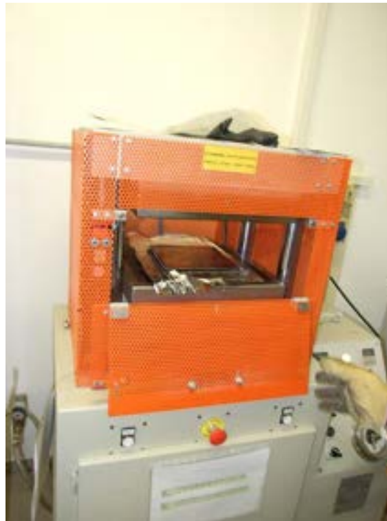
Fig.7 Pressa per lo stampaggio delle lastre
