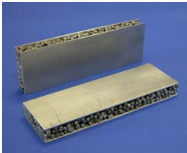
Figura 32: Campioni di materiale cellulare per prove meccaniche di flessione
