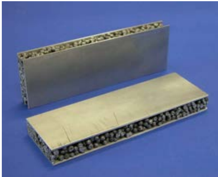
Fig.2: campioni di materiale cellulare per prove meccaniche di flessione
