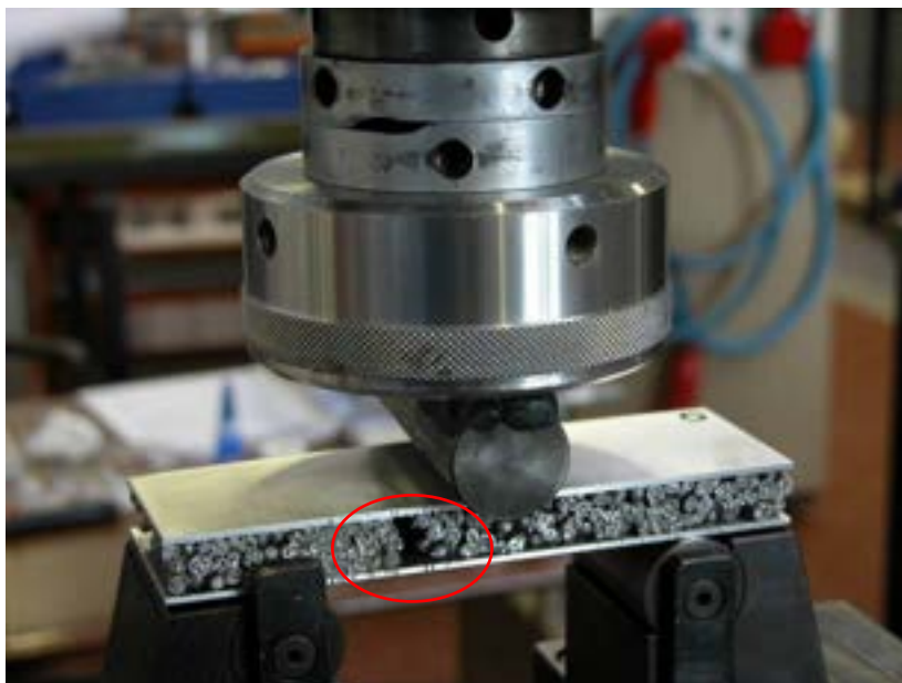
Fig. 12. Cavità macroscopica all'interno del campione 0.
