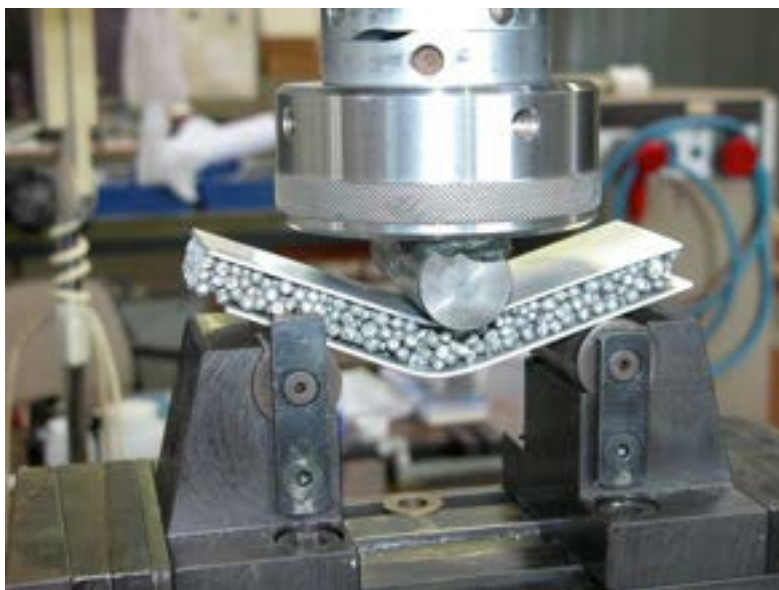
Fig. 10. Campione 0 dopo prova di flessione
