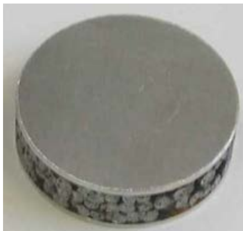
Figura 8: Campioni di materiale cellulare per misure di conducibilità termica
