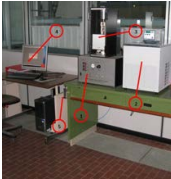
Fig. 13. Termoflussimetro Unitherm 2022 per la misura della conducibilità termica – 1 pannello di controllo; 2 chiller; 3 stack di misura; 4 PC con sw di gestione ed acquisizione dati; 5 impianto azoto
