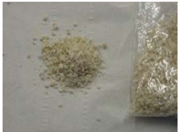
Fig.6 Granuli in PP e 18% di fibra di vetro
