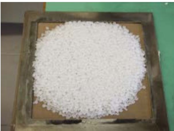
Fig.8 Stampo caricato con pellets di PP puro
