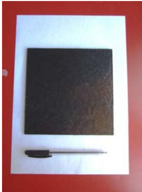
Fig 10 Lastra in PP+kenaf ottenuta dallo stampaggio
