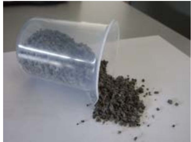
Fig.2 Compound in PP con il 16-20% di kenaf
