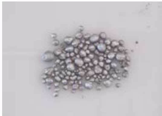
Figura 30: Granuli di alluminio dopo trattamento a 650°C
