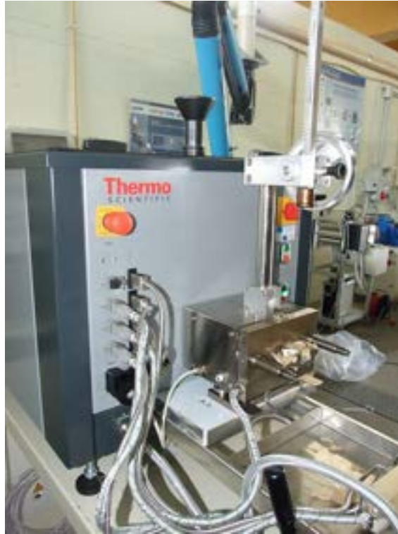
Fig. 4 Mixer per la realizzazione del compound in PP e 18% in fibra di vetro
