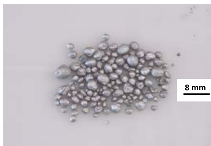
Figura 3: Granuli di alluminio dopo trattamento a 650°C
