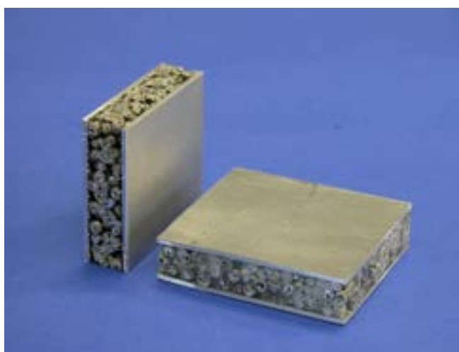
Figura 6: Campioni di materiale cellulare per prove meccaniche di compressione
