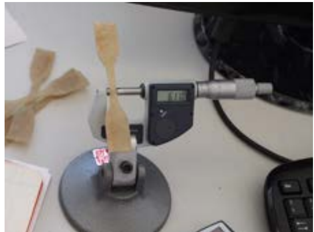
Fig.12 Controllo dimensionale dei provini ricavati
