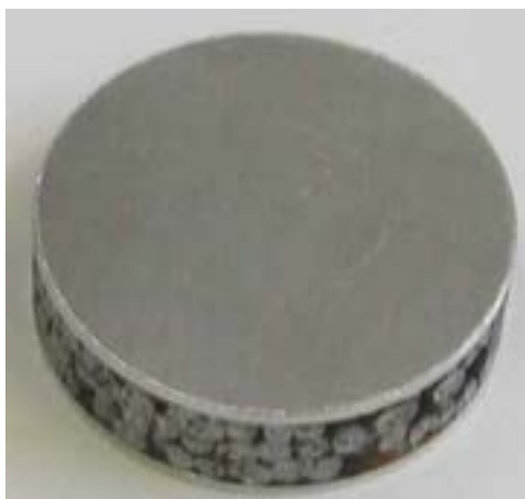
Figura 33: Campioni di materiale cellulare per misure di conducibilità termica
