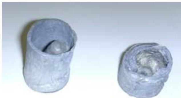
Figura 21: Sx: Tubo con campione AlMg1Si0.6 tenuto a 675°C per 10 min. Dx: Tubo con campione AlSi10.
