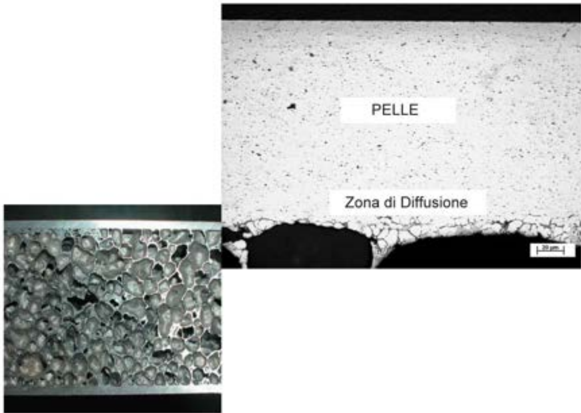
Figura 5: Aspetto dei pannelli in AFS e osservazione macroscopica del legame pelle - AFS.
