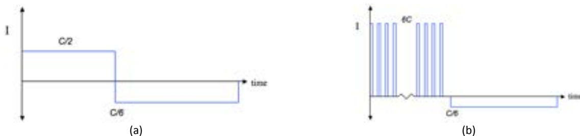
Figura 2.3 – Cicli utilizzati per lo studio presentato in [8]: (a) ciclo di energia; (b) ciclo di potenza.
