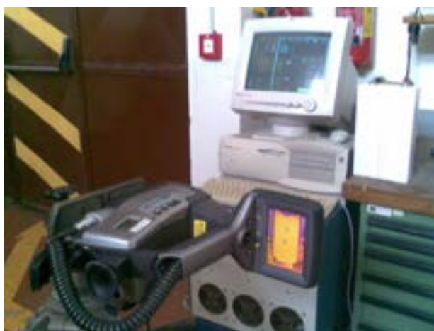
Fig. 10 –Termografia su batteria in esercizio
