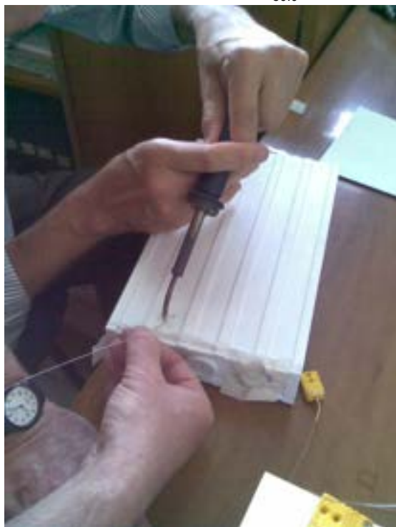
Fig. 12 –Montaggio del sensore di temperatura nel punto caldo
