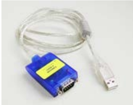
Figura 17. Adattatore Lawicel CANUSB impiegato per la connessione del PC al bus CAN[20]
