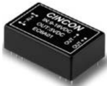
Figura 11 Convertitore DC/DC Cincon EC6A01 con protezione continua rispetto al cortocircuito usato come generatore di corrente (caricabatterie) nella sezione di equalizzazione attiva. Le dimensioni sono 31.8 \times 20.3 \times 10.2 \text{ mm}^3
