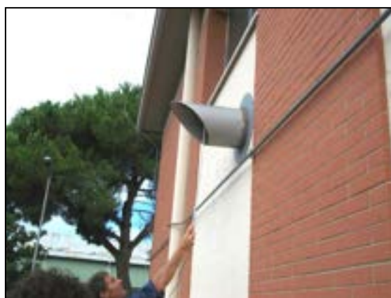
Figura 14. Misure della velocità dell'aria effettuate con anemometro a ventolina in corrispondenza dell'uscita a bocca di lupo della cappa B
