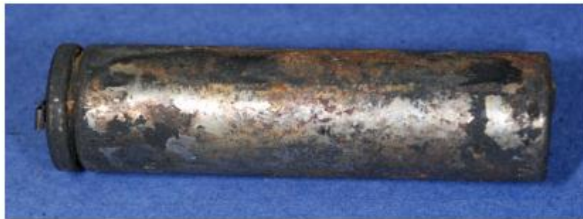
Figura 3. Una cella 18650 nella quale è avvenuta una reazione fuggitiva (Thermal runaway)
