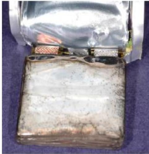
Figura 2. Esempio della fusione del separatore dovuto ad abuso elettrico
