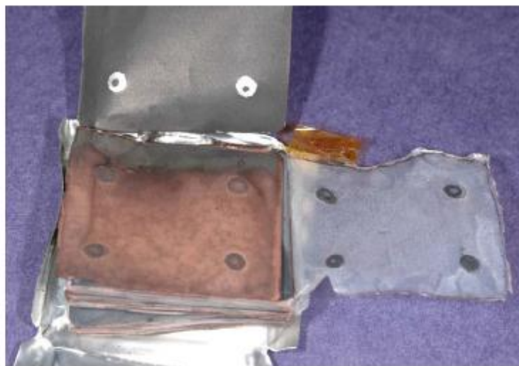
Figura 5. L'anodo di una cella ricoperta di rame dopo sotto-scarica ripetuta
