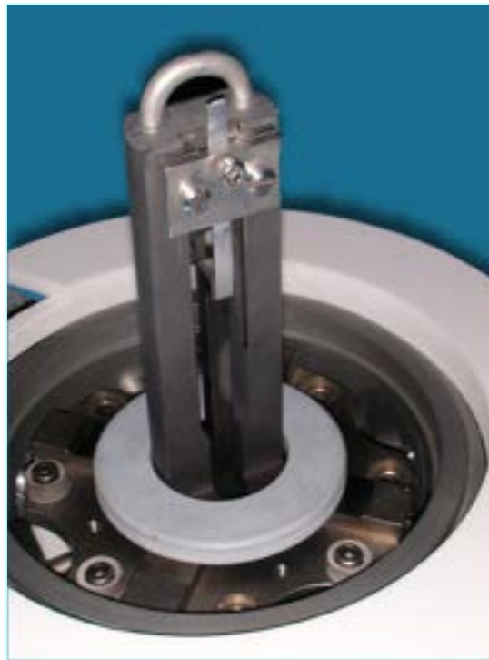
Fig. 9- Particolare del portacampioni. Il provino di alluminio è montato nella geometria a trave incastrata nel portale della camera di misura dell'analizzatore VRA-1604.
