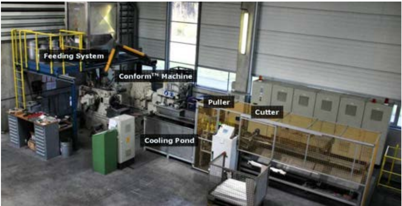
Figura 4: Impianto di produzione di Precursori presso MEPURA gruppo ECKA gralules che detiene il marchio ALulight™ [4]
