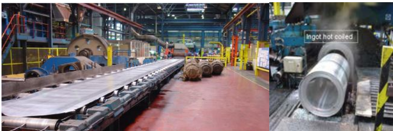
Figura 11: Laminazione in impianti industriali del contenitore per AFS [4]
