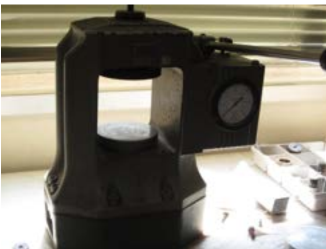
Figura 5: Pressa da laboratorio da 20 ton utilizzata per la realizzazione delle pasticche con relativa matrice epunzione con "incudini" di 5 mm di diametro
