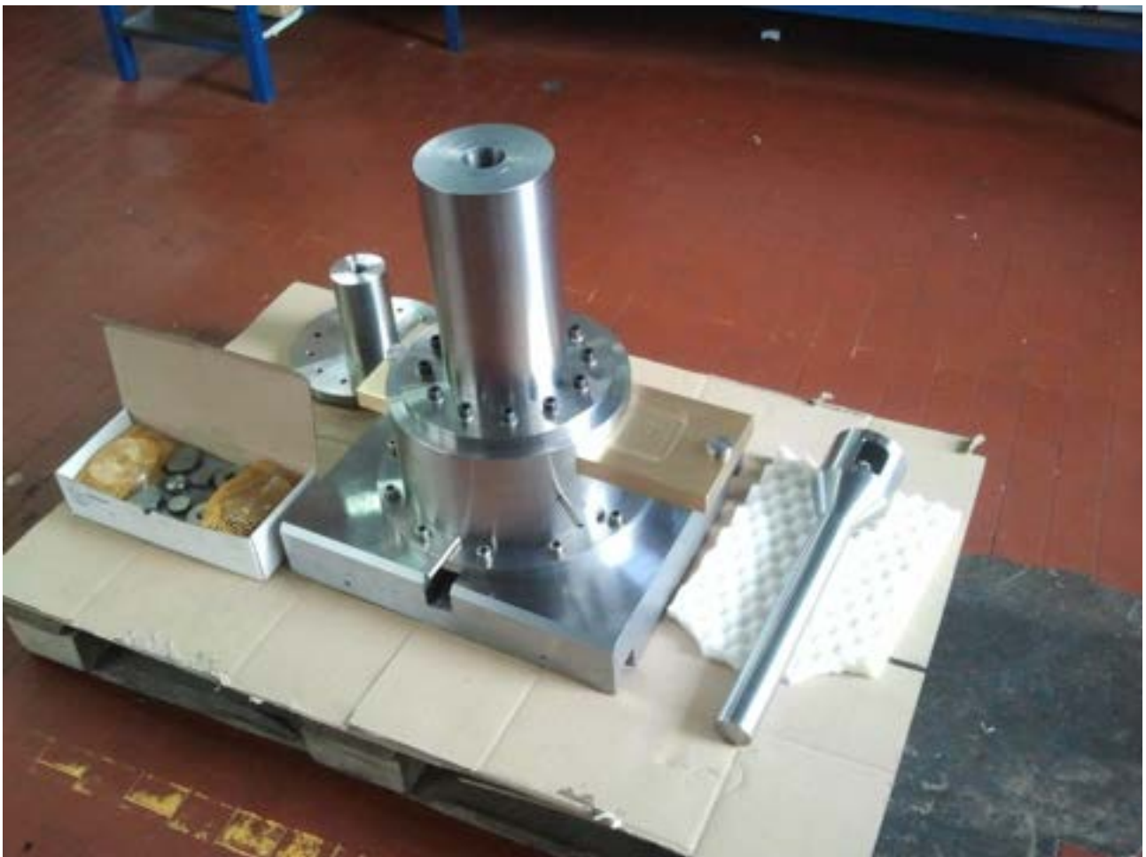
Figura 17: Attrezzature completa nella configurazione di compattazione 50 mm con tutte le parti per adattarsi a compattazione a caldo da 30 mm e d estrusione 10 mm
