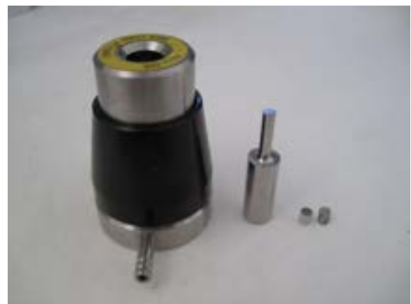
Figura 5: Pressa da laboratorio da 20 ton utilizzata per la realizzazione delle pasticche con relativa matrice epunzione con "incudini" di 5 mm di diametro
