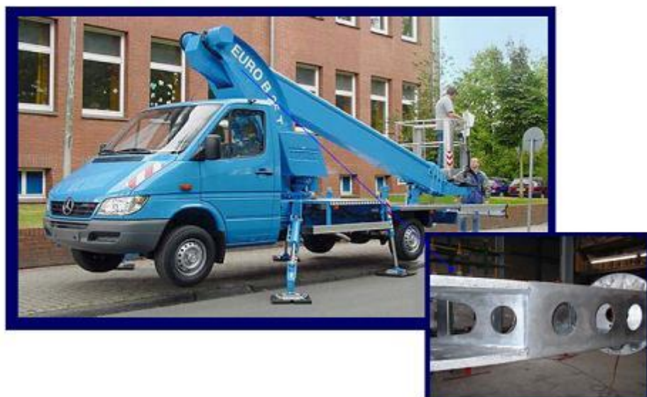
Figura 3: Applicazioni di AFS in componenti strutturali del settore automotive
