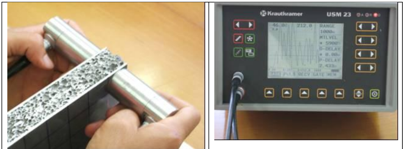
Figura 8: Tecnica TT – Schiuma metallica in alluminio – il componente è tra le due sonde – Strumento a bassa frequenza
