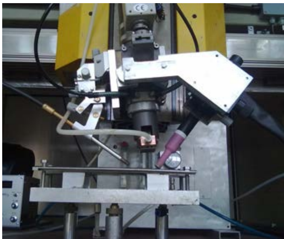
Figura 2: Nuovo Set Up di saldatura Laser TIG Filo (LTF) con staffa a rigidità migliorata e torcia per saldatura automatica
