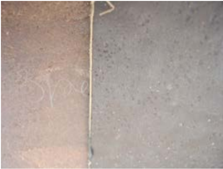
Fig. 27 Fotografia di un elemento con materiale di partenza (sinistra) ed elemento con materiale riciclato(destra)
