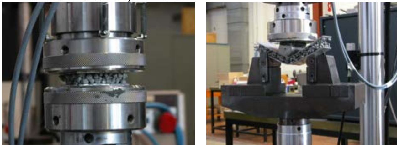
Figura 10: configurazione del sistema di prova rispettivamente per compressione (sin.) e flessione a tre punti (dx.)
