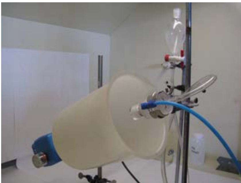
Figura 3: immagine frontale e laterale del sistema di granulazione in scala laboratorio
