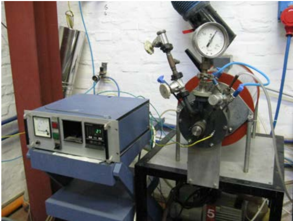
Figura 4: forno di pirolisi con relativo sistema di programmazione/regolazione
