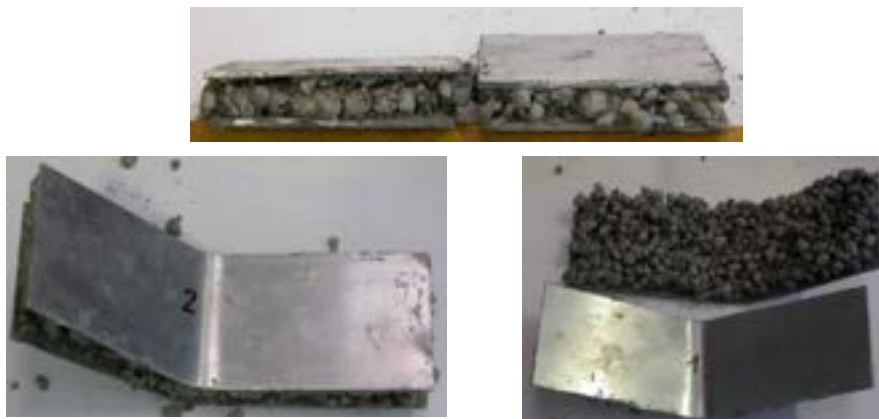
Figura 14: aspetto dei campioni dopo le prove di compressione (alto) e flessione
