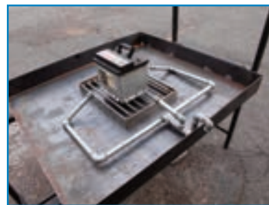
Banco prova incendio per celle/moduli litio-ione
