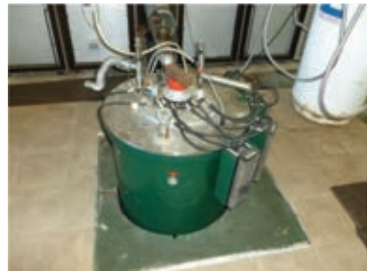
Criostato equipaggiato con magneti superconduttore da 14 T
