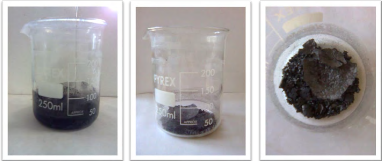
Figura 48. A sinistra: soluzione di TYZOR ® -LA in cui è stato disperso il carbone Super P dopo sonicazione. Al centro: La stessa soluzione dopo evaporazione del solvente. A destra. Materiale ottenuto dopo calcinazione del residuo dell'evaporazione condotto a 400°C per 2 ore.
