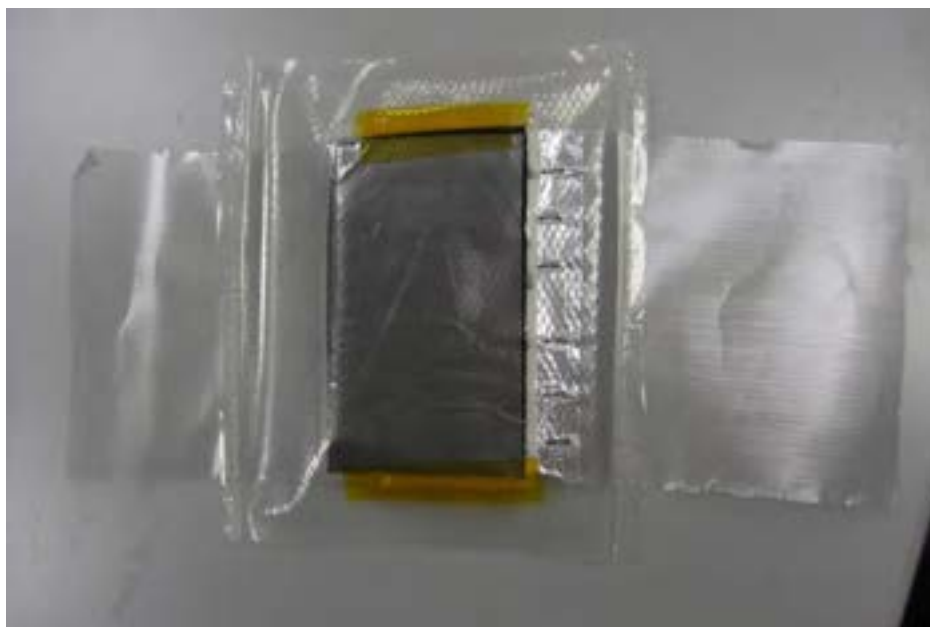
Figura 32. Immagine della batteria pronta per la caratterizzazione elettrochimica dopo aver saldato i quattro lati ed aver operato un leggero vuoto all'interno.
