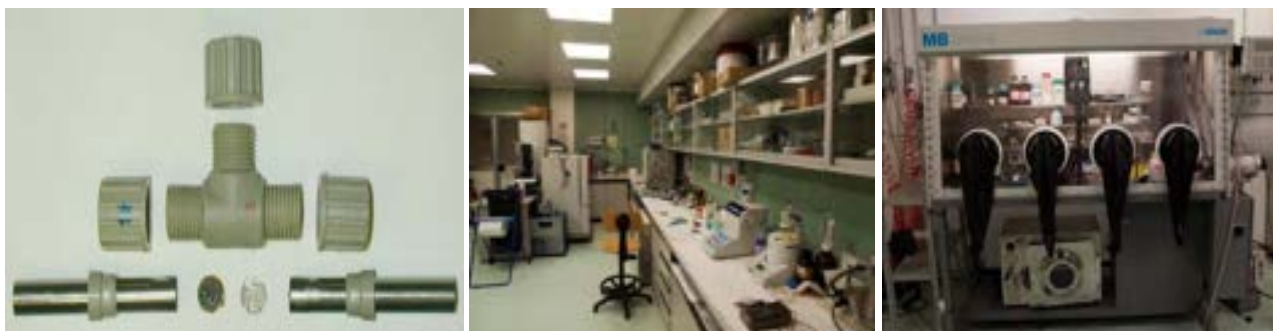
Figura 7. Pannello sinistro: cella di prova in scala di laboratorio per elettroliti liquidi. Pannello centrale: camera secca; Pannello destro: scatola a guanti.
