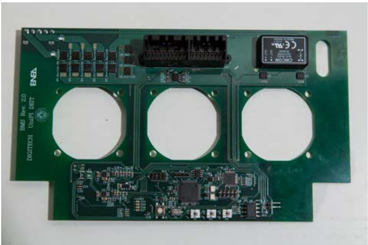
Figura 16 Fotografia del lato superiore della scheda del BMS completamente montata.
