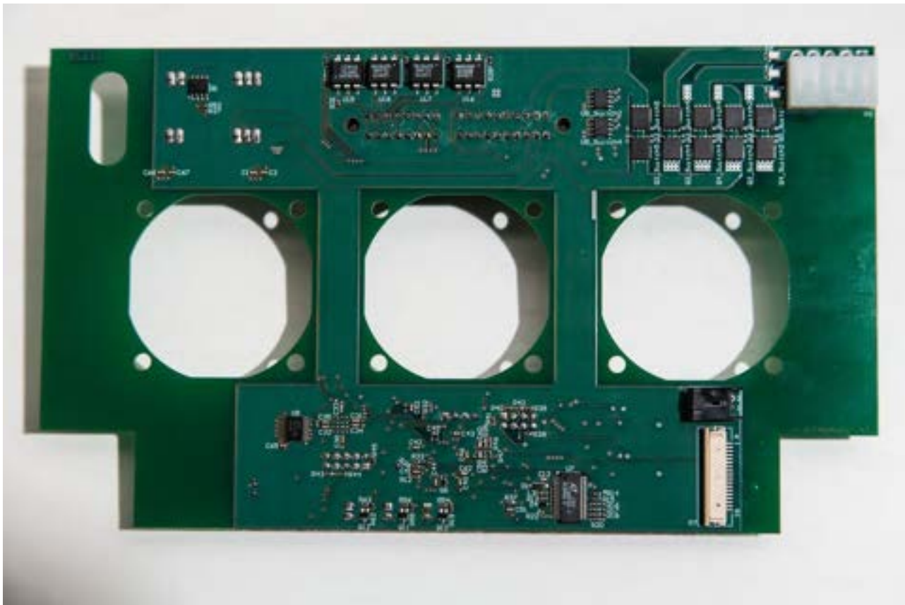
Figura 17 Fotografia del lato inferiore della scheda del BMS, dalla parte delle celle, completamente montata.
