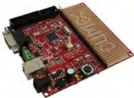
Figura 9. Circuito Olimex per l'interfaccia BMS-dispositivo.
