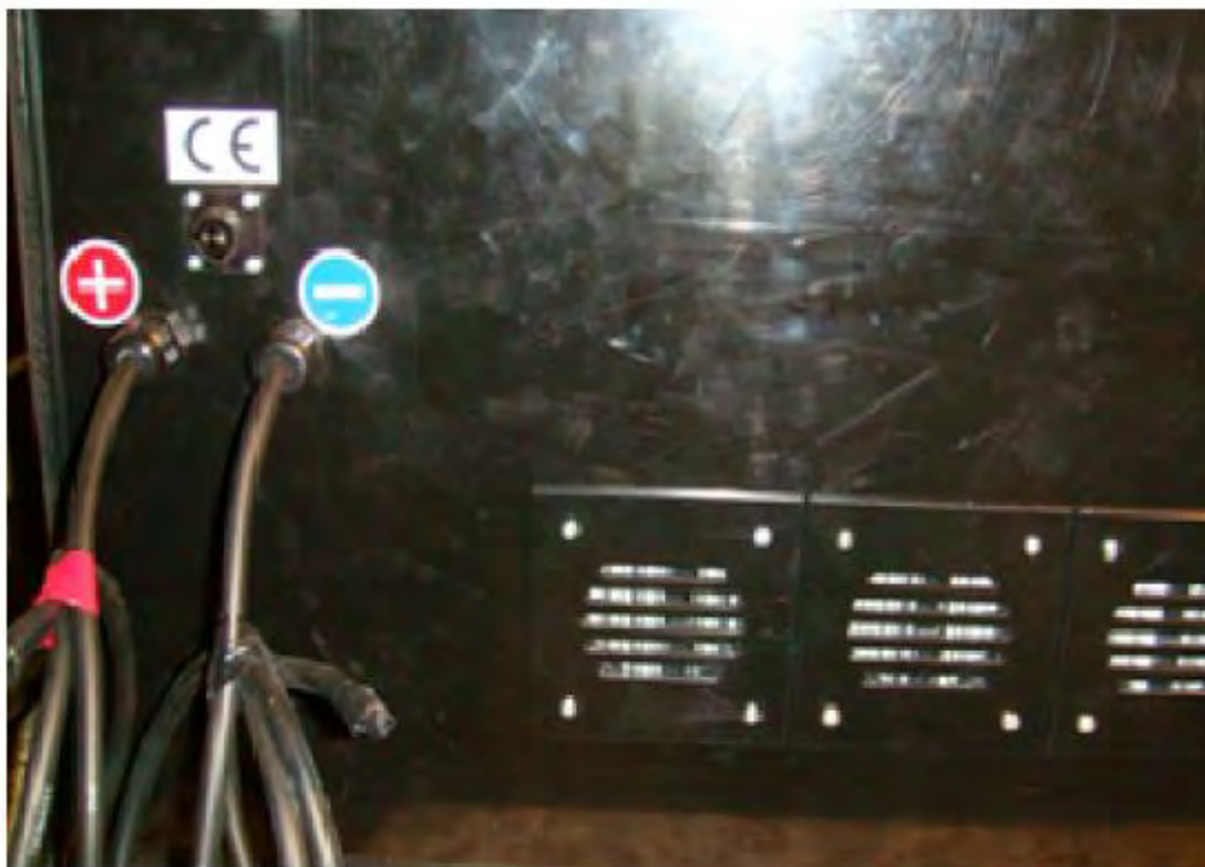
Figura 8. Particolare uscita di potenza ed alimentatore 12V BMS.
