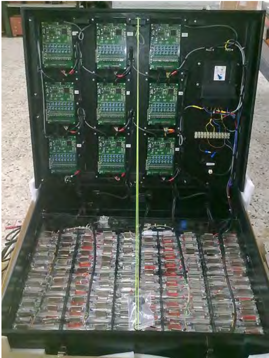
Figura 2. Vista della parte interna del pacco batterie.
