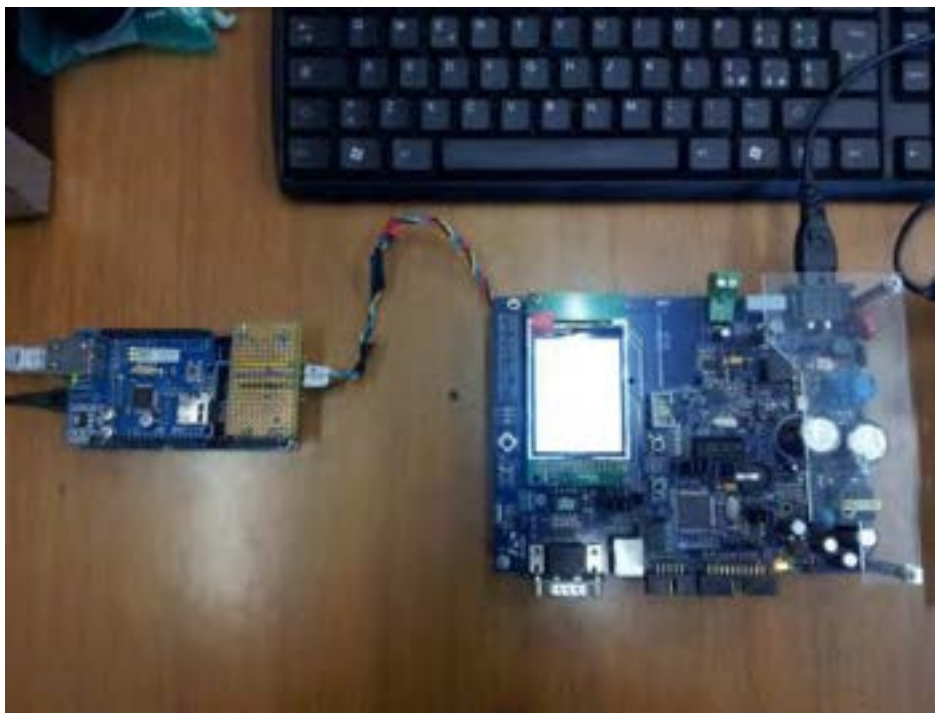
Figura 7. Particolare del sistema di misura: scheda di interfaccia ethernet e concentratore, da installare in cabina secondaria per la gestione dei dispositivi di interfaccia via power-line.
