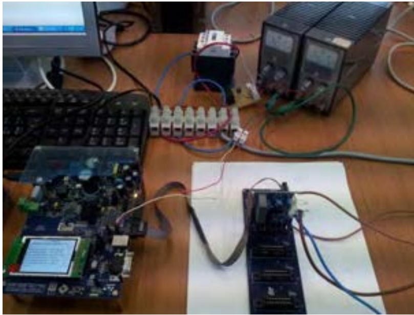
Figura 8. Particolare del sistema di misura: DDI, scheda di acquisizione e contattore.
