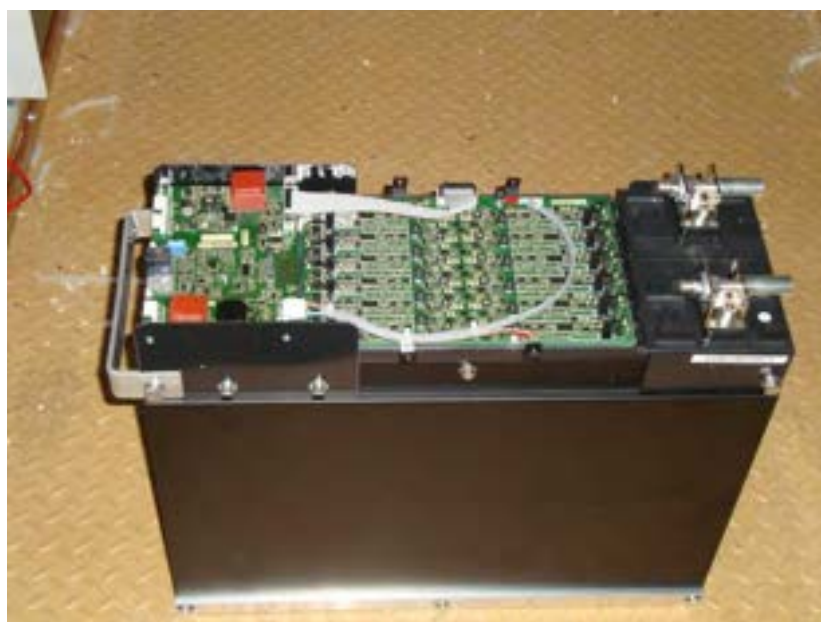
Figura 5. Pacco di accumulatori al litio polimero
