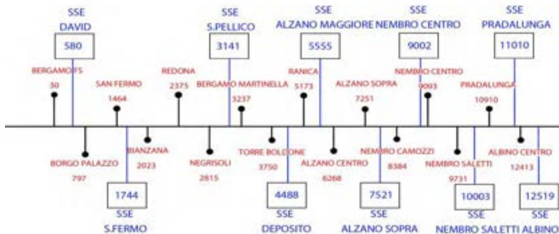
Figura 30: Posizione progressiva SSE e Fermate attive [m]
