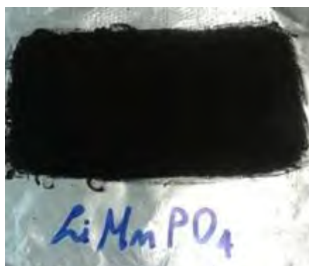
Figura 5. Immagine del nastro elettrodico preparato con il materiale di formula 0.9 LiMnPO 4 0.1 Li 3 V 2 (PO 4 ) 3 /C5,5% e polimero vinilico.
