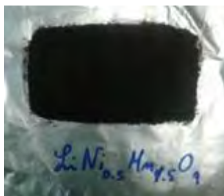
Figura 12. Immagine del nastro elettrodico preparato con il materiale di formula \text{LiNi}_{0.5}\text{Mn}_{1.5}\text{O}_4 e polimero vinilico.
