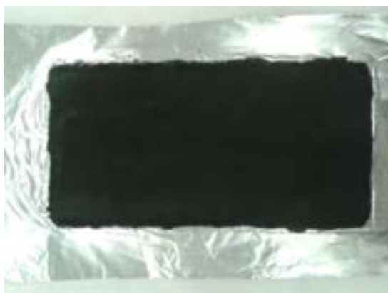
Figura 16. Immagine dell'elettrodo catodico depositato sul collettore di corrente di alluminio.
