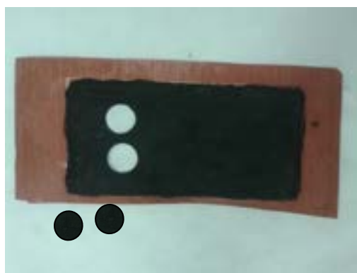
Figura 21. Immagine dell'elettrodo anodico a base di Grafite HD-G25.
