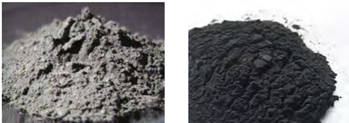
Figura 5. A sinistra: immagine del materiale catodico a base di \text{LiFePO}_4 . A destra immagine della grafite MCMB-G25.
