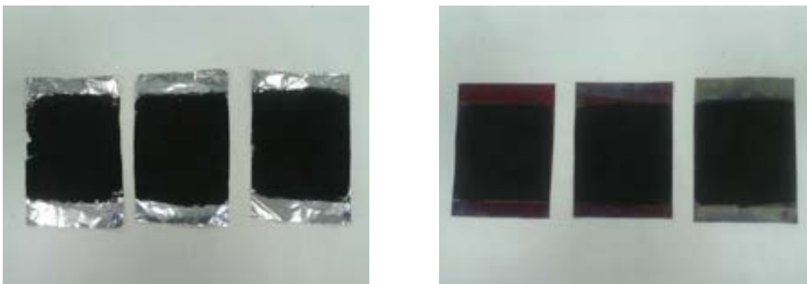
Figura 26. Elettrodi catodici a base di LiFePO 4 (a sinistra) ed elettrodi anodici a base di grafite HRD-G12 (a destra) come appaiono dopo aver rimosso i bordi laterali del portacorrente.
